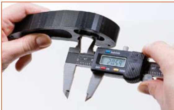
FIGURE 8 : ON MESURE LE DIAMETRE INTERIEUR DE L'EMBOITEMENT DU MOTEUR AU CALIBRE A COULISSE
