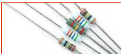
DOCUMENT 2 : RESISTORS UTILISES DANS LES CIRCUITS ELECTRIQUES
