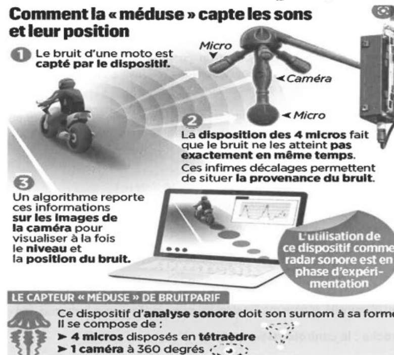
Figure 2. Fonctionnement du dispositif « méduse ». https://www.leparisien.fr/
